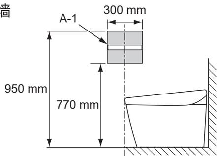
**12** 暂时安装在步骤 11 中所决定的位置后，请确认 A-1 的信号接收状态。
